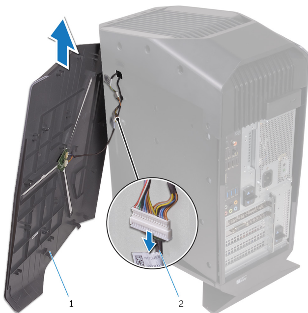
Figur 5. Ta av dekselet på høyre siden
