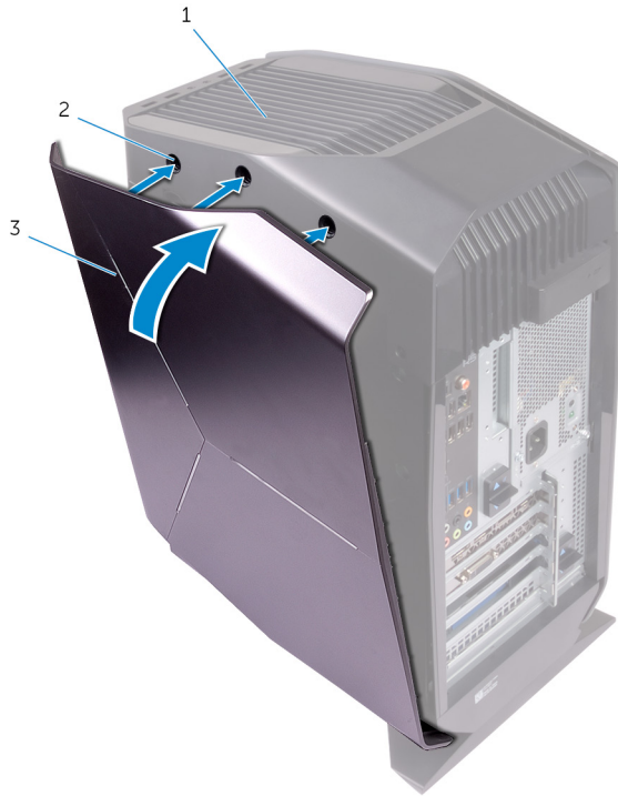
Figur 7. Sette på plass dekselet på høyre siden
